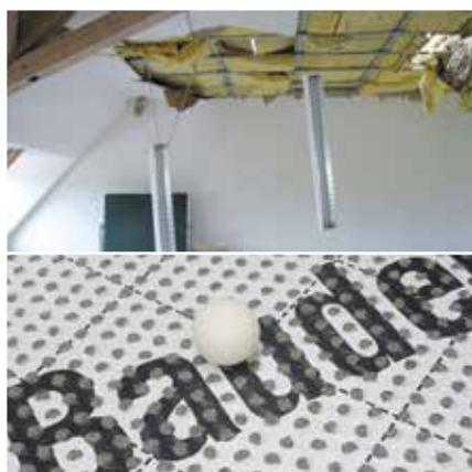
Selbst der höchstmöglichen Belastung mit der Geschwindigkeit von 200 km/h hielten die Wärmedämmelemente stand.
