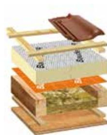
Aufdachdämmelemente **BauderPIR** aus dem Hochleistungsämmstoff PU-Hartschaum dämmen nicht nur extrem gut (WLS023) und sind dabei besonders schlank, sie sind auch ein ausgezeichneter Schutz gegen Hagel und Schlagregen.
