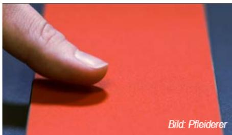
Abb. 4 Dekor einer HPL-Kompaktplatte mit dreidimensionalem Effekt. Die Platte scheint aus kleinen quadratischen Bronzetafeln zusammengesetzt zu sein.
