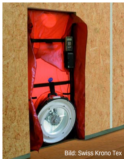
Abb. B1.3 Bei der „Blower-Door-Messung“ wird ein Luftdruck wie bei Windstärken 4-5 simuliert. Ursachen für Zugluft im Raum (Leckagen) werden dann erkennbar.
