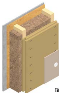
Abb. C6.20 Darstellung einer Gebäudeabschlusswand aus einem Prüfzeugnis (abP) Gutex P-SAC-02/II-770
