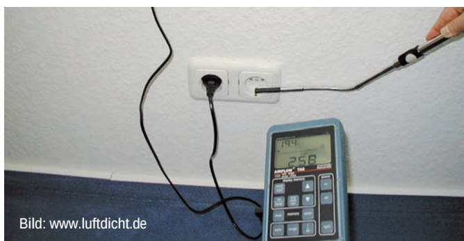
Abb. C2.7 Hier das Beispiel einer Steckdose, die beim Einbau nicht abgedichtet wurde. Diese kleine Leckage auf der Raumseite der Wand genügt, um schleichend für eine Wasseransammlung in der Wand zu sorgen.
