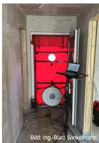
Abb. C2.13 Die Differenzdruckmessung wird gemäß Gebäudeenergiegesetz (GEG) nach DIN EN ISO 9972 durchgeführt. Weitere Hinweise enthält DIN 4108 Teil 7.
