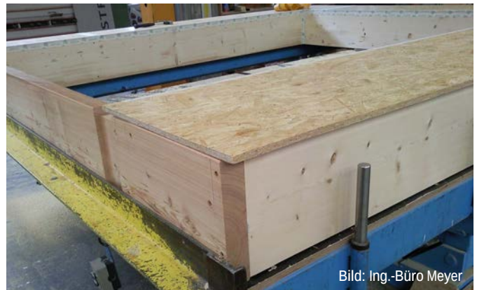
Abb. G2.24 (Stufe 1) Das Rahmenwerk wurde mit der Aussteifenden OSB-Beplankung belegt. Das Element formstabil.
