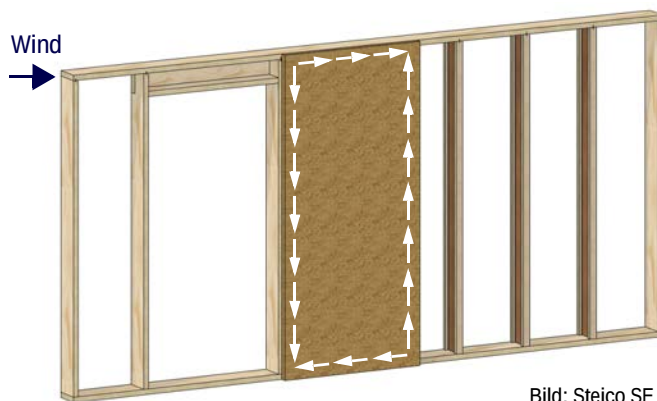
Abb. C6.21 Die Holzfaser-Dämmplatten können zur Aussteifung der Konstruktion mit angesetzt werden. In der Zulassung / Bauartgenehmigung (abZ / abG) werden Bemessungswerte für eine Befestigung mit Breitrückensklammern angegeben.
