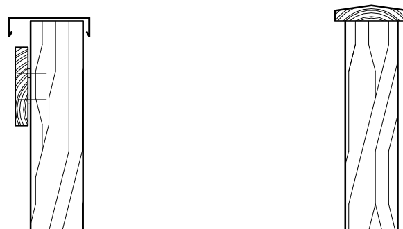
Abb. F4.3 Stützen werden oberseitig mit Hutelementen abgedeckt. Obere Abdeckungen von Geländern dürfen als Verschleißbauteile (nach Fachregel 02 [2]) ausgeführt werden. Sind dann allerdings als nichttragende Bauteile und leicht demontierbar zu konstruieren.
