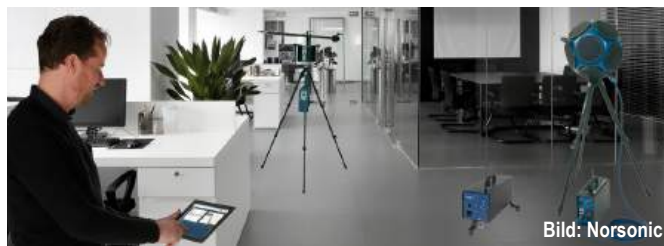
Abb. C7.1 Kein anderes Feld der Bauphysik ist derart schwer planerisch vorhersehbar und ebenso einfach wie exakt später prüfbar. Der Schallschutz birgt ein hohes Mängelpotenzial. Bild: Messanordnung für den Luftschall (Norsonic).
