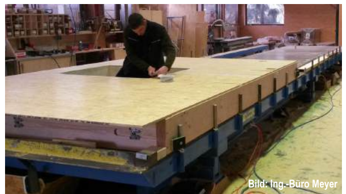
Abb. G1.8 Das Fertigen des Rahmenwerks mit OSB-Beplankung ist relativ einfach. Allerdings ist die im Element „gespeicherte Arbeitszeit“ dabei recht gering. Die Grundkosten der Elementierung sowie dem Handling, der Logistik und der Kranmontage fallen unabhängig vom Vorfertigungsgrad an, lassen sich bei der „Stufe 1“ weniger gut umrechnen.
