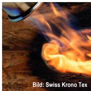
Abb. C6.19 Für dieses Bauprodukt „schwerentflammbare OSB-Platte“ wird in der Leistungserklärung (DoP) das Brandverhalten B-s1,d0 aufgeführt (Euroklasse nach DIN EN 13501-1).
