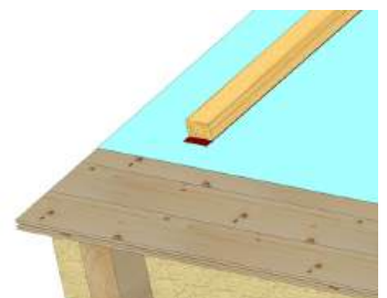
Abb. E3.12 Nahtgefügte Unterdeckung \uparrow der Klasse 2, auf einer Schalung verlegt. Unterhalb der Konterlatten sind bei der Ausführung „regensicher“ Nageldichtbänder angeordnet.
