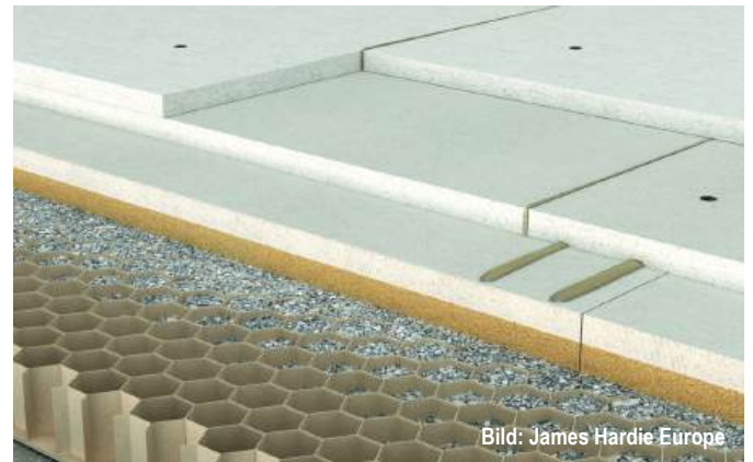
Abb. E5.6 Eine Wabenschüttung mit einer Schüttdichte von ca. 1500 \text{ kg/m}^3 erzielt bei einer Höhe von 60 mm das erforderliche Flächengewicht von 90 \text{ kg/m}^2 .
