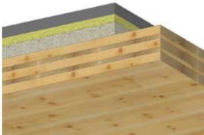
Abb. C7.29 Eine Rohdeckenbeschwerung ab 90 kg/m 2 ist die entscheidende Stellschraube zur Optimierung von Holzmassivdecken. siehe Tab. C7.33
